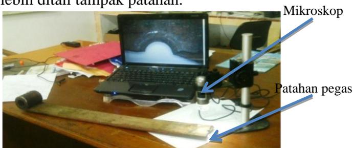
Gambar 5. Mikroskop foto image untuk pengamatan patahan
