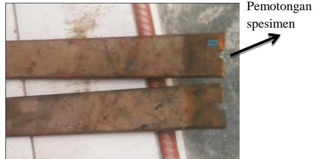
Gambar 6. Lokasi pemotongan pegas sebagai sampel.
